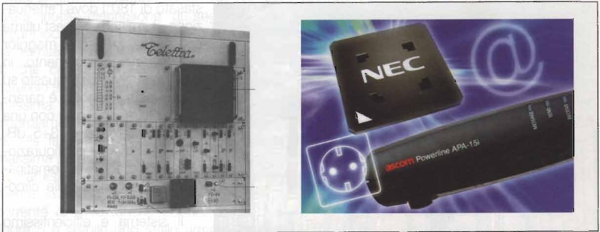
Figura 6 - A confronto un terminale ad onda convogliata degli anni 70 montato su rack 19 pollici (il primo completamente a transistor) con un terminale d'utente PLC costruito dalla ASCOM Svizzera, tratto da un comunicato stampa del 19/4/2002, a Berna, dove annunciano la cooperazione con la NEC nel settore della comunicazione elettrica. ( www.ascom.com ).
